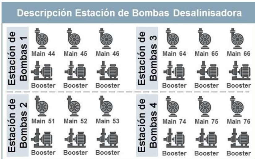
Figura 21 - Configuración bombas impulsión agua desalada
