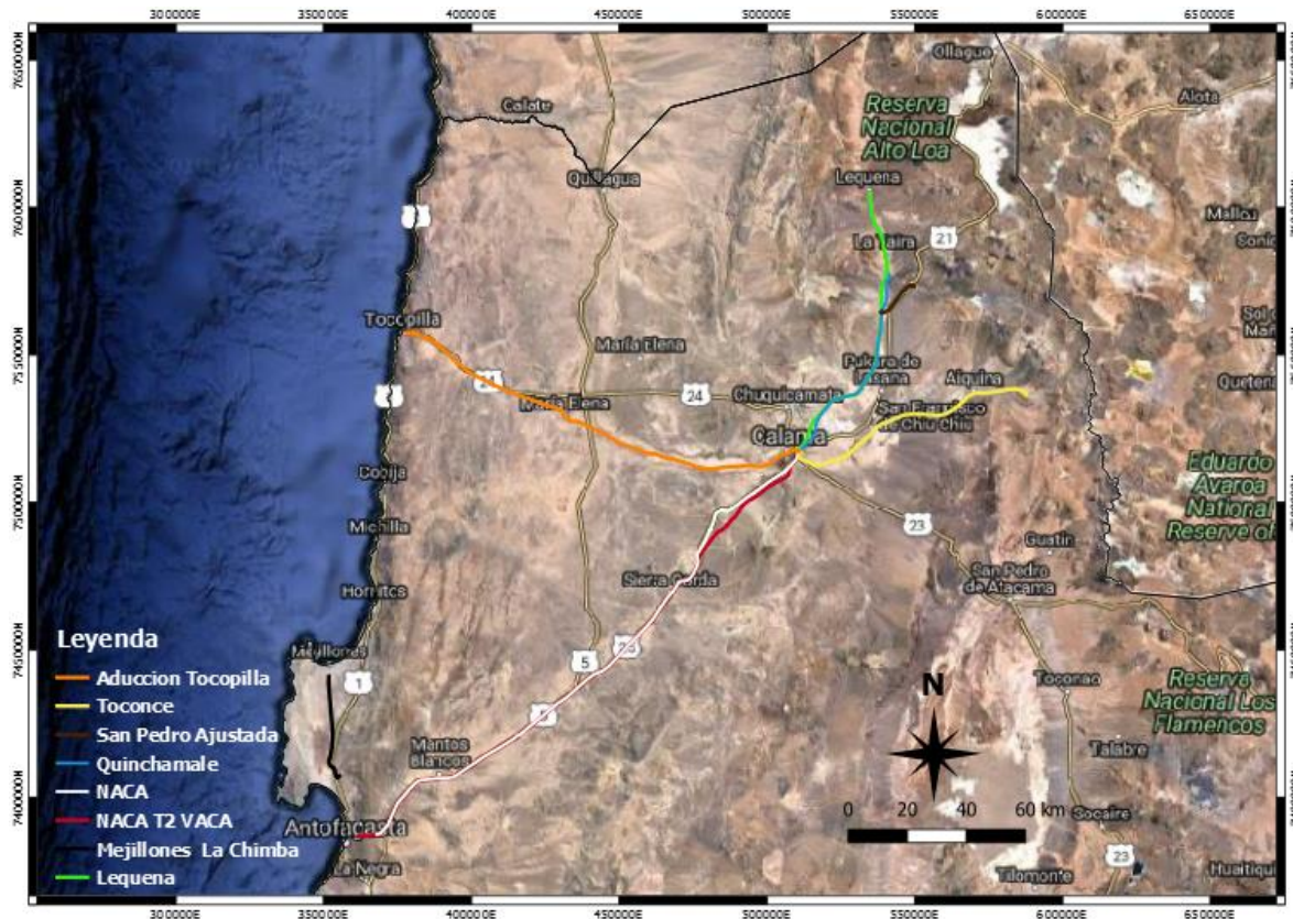
Figura 3.5. Tuberías de suministro para agua potable.
