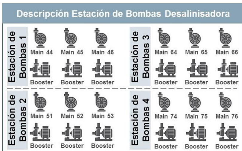
Figura 28 - Configuración bombas impulsión agua desalada
