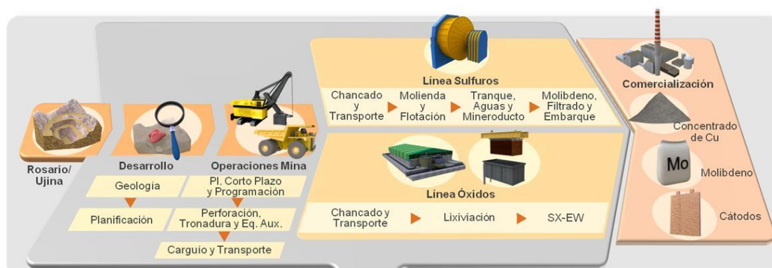
Figura N° 1: Diagrama del proceso productivo de cobre y molibdeno de Collahuasi.
