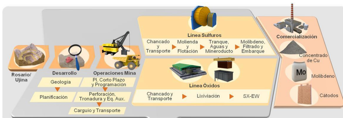
Figura N° 1: Diagrama del proceso productivo del concentrado de cobre, cátodos de cobre, y concentrado de molibdeno de Collahuasi.
